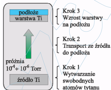
Rys. 1.28. Etapy w metodzie naporowywania cienkich warstw
